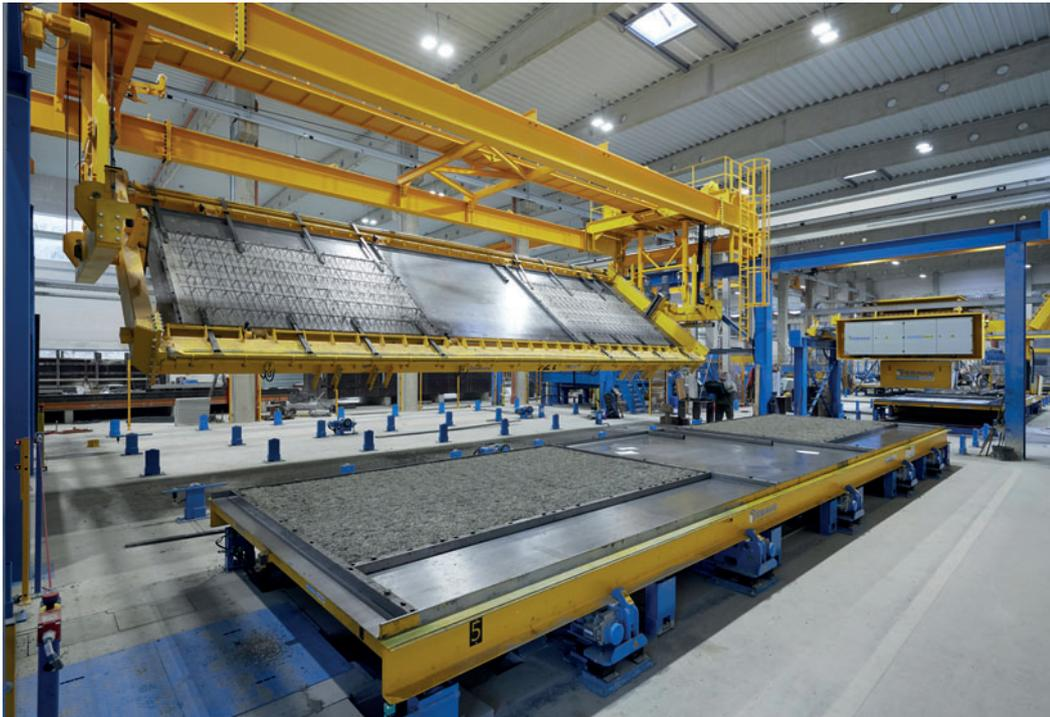
*Zur Herstellung von Doppelwänden wird die ausgehärtete Erstschaale gewendet und über der frisch betonierte Zweitschale abgesetzt. Dieser Prozess wird mit einer automatischen Wende-einrichtung realisiert.*
