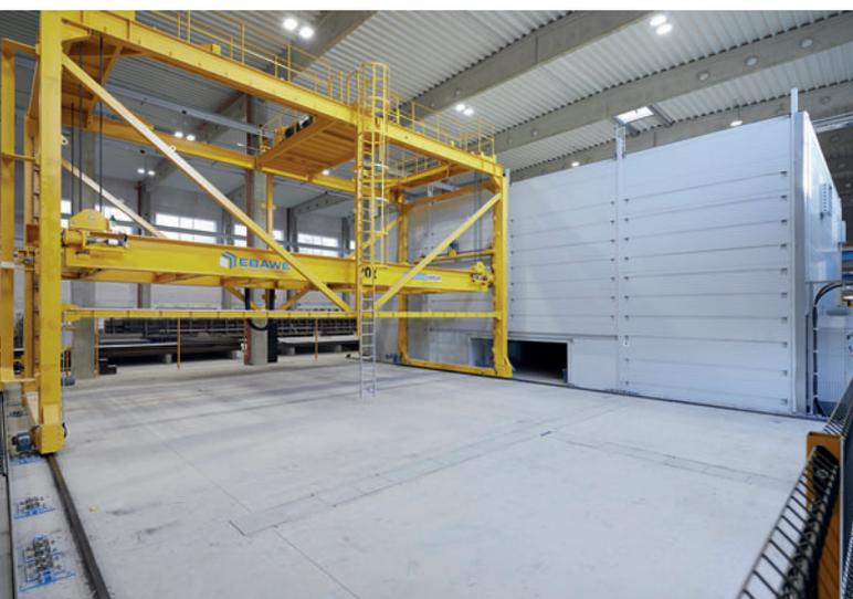
*Das Stapelregal bietet Platz für 36 Paletten und wird über eine Hubschlebeebühne bedient.*
