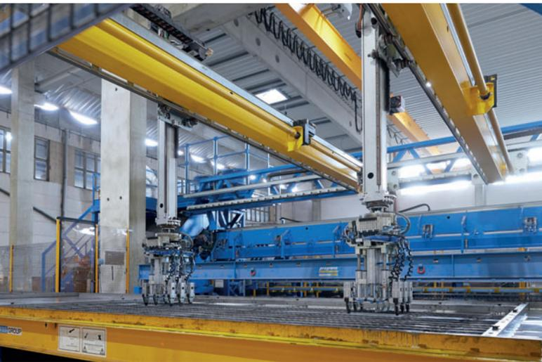
*Auch die Bewehrung wurde im neuen Doppelwand- und Elementdeckenwerk in Könnern weitestgehend automatisiert. Der Verlegeroboter Wire Center setzt sowohl Längs- und Querstäbe als auch die Gitterträger in die geschalteten Paletten.*
