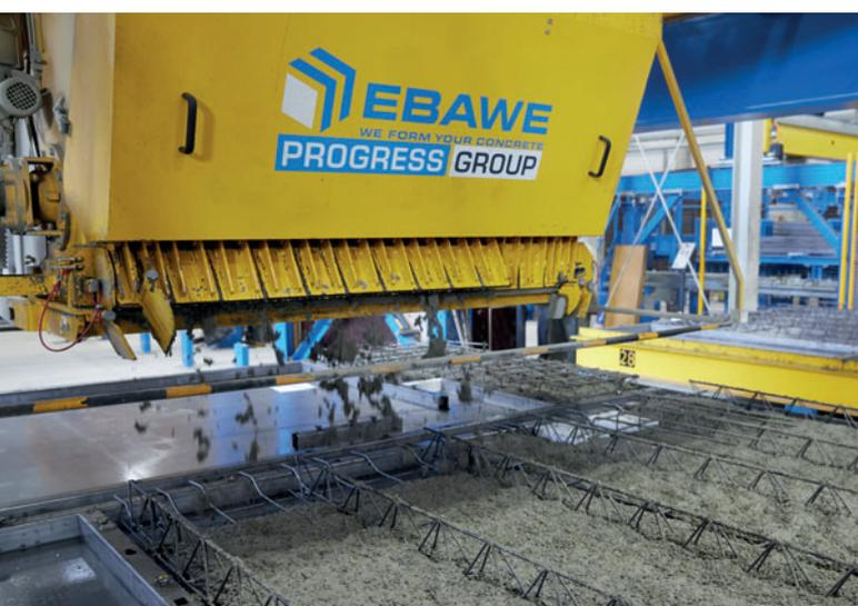
*Der neue Betonverteiler von Ebawe übernimmt das vollautomatische Betonieren der Elementdecken- und Doppelwandelemente.*
